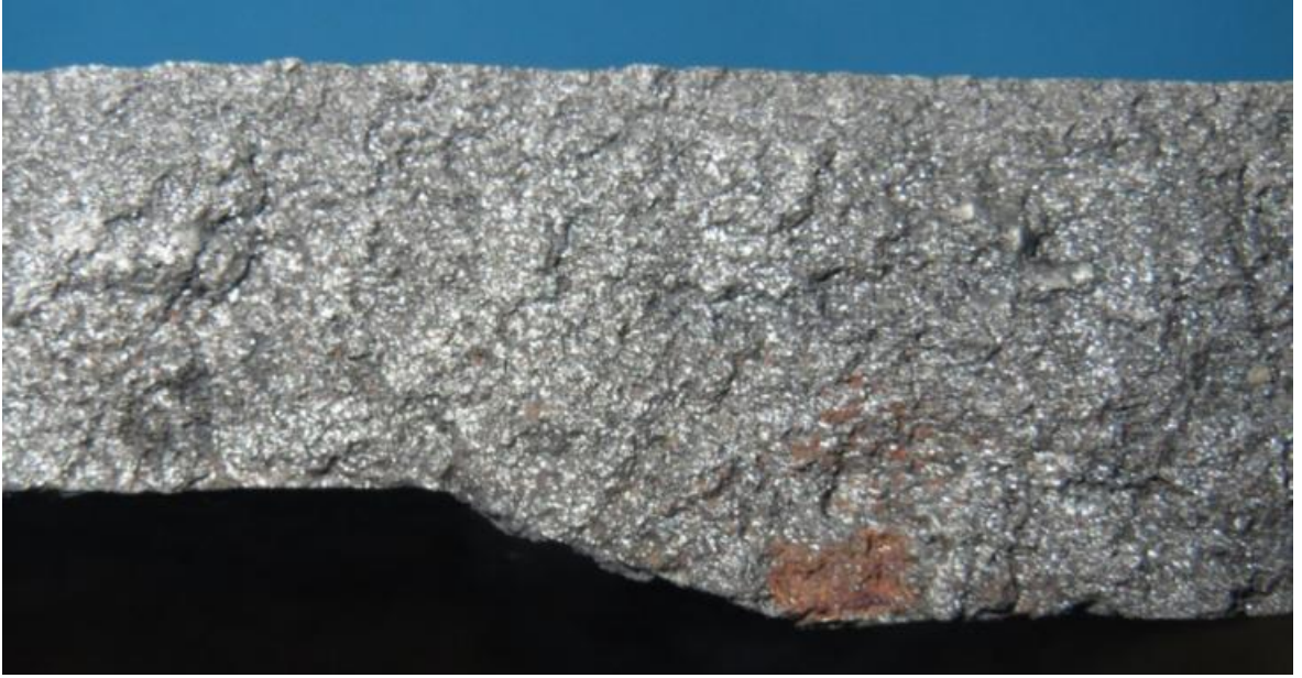
Resim 14b: Tatlı su ve koruyucu katkılı asit ile temizlemeden sonra çatlak yüzeyini ve çatlak yüzeyinde pastan etkilenen küçük bir alanı gösteren yakından görünüş
