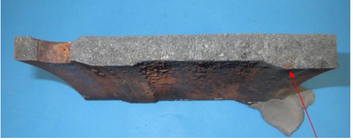
Resim 14a: Alt conta sınırına yakın küçük bir alan haricinde pas temizlenmiştir.
