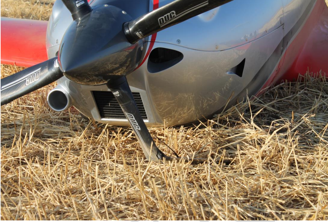
Resim-3: Hava Aracındaki Pervane Hasarı
