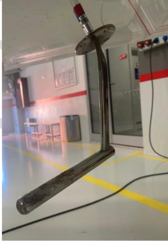
Resim-3: Hasarlı Pitot Tüpü
