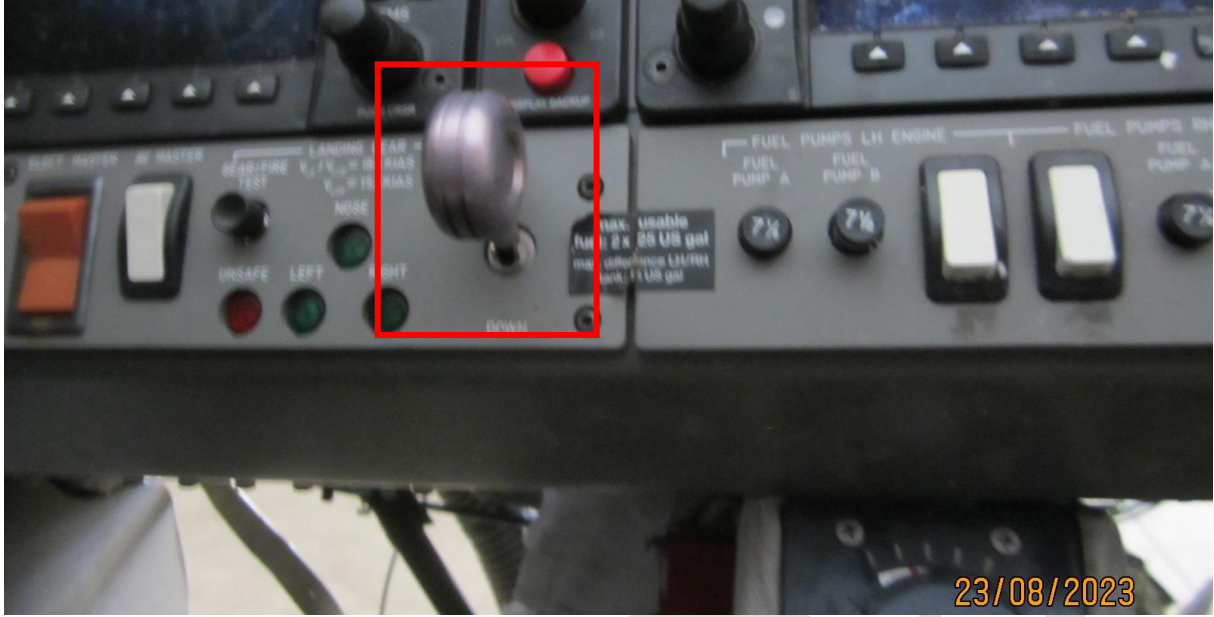
Resim-7: Kaza Sonrası İniş Takımı Kolu Yukarı Pozisyonda
