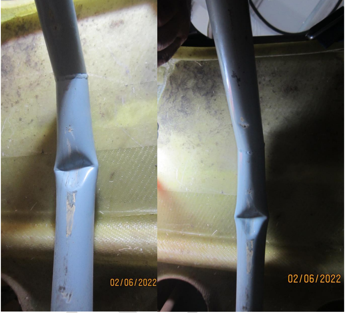
Resim-5: İrtifa Dümeni Tork Tüpünde Meydana Gelen Hasar
