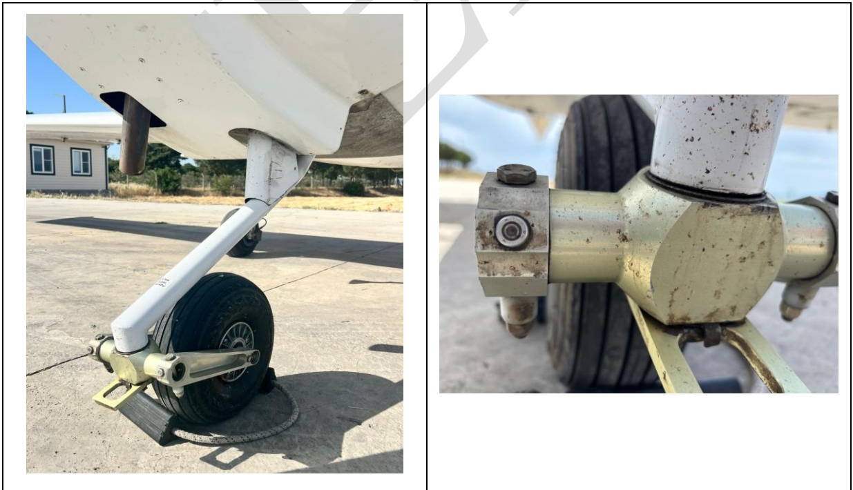
Resim-3: Hasarlı Burun İniş Takımı
