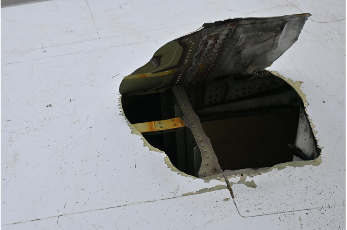
Resim-4: Sol Kanat Hasarı
