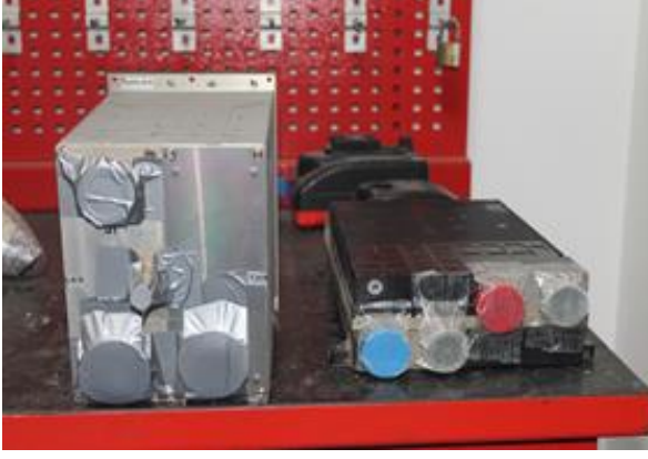
Resim-9: Emniyete Alınmış VEMD ve DECUC
