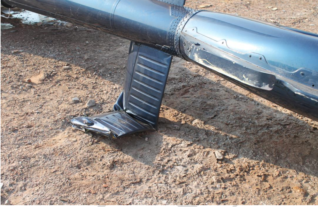
Resim-2: Sağ Horizontal Stabilizer
