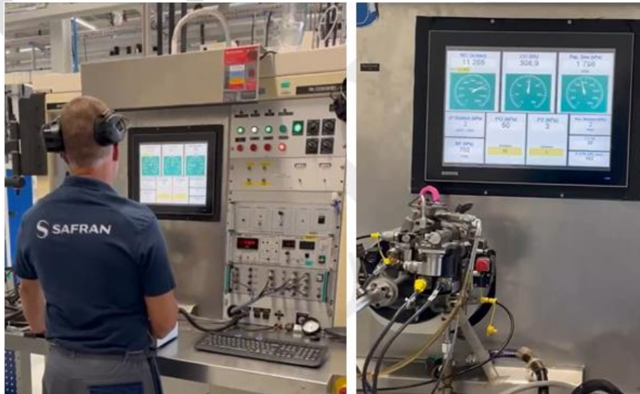
Resim-22: HMU Testi
