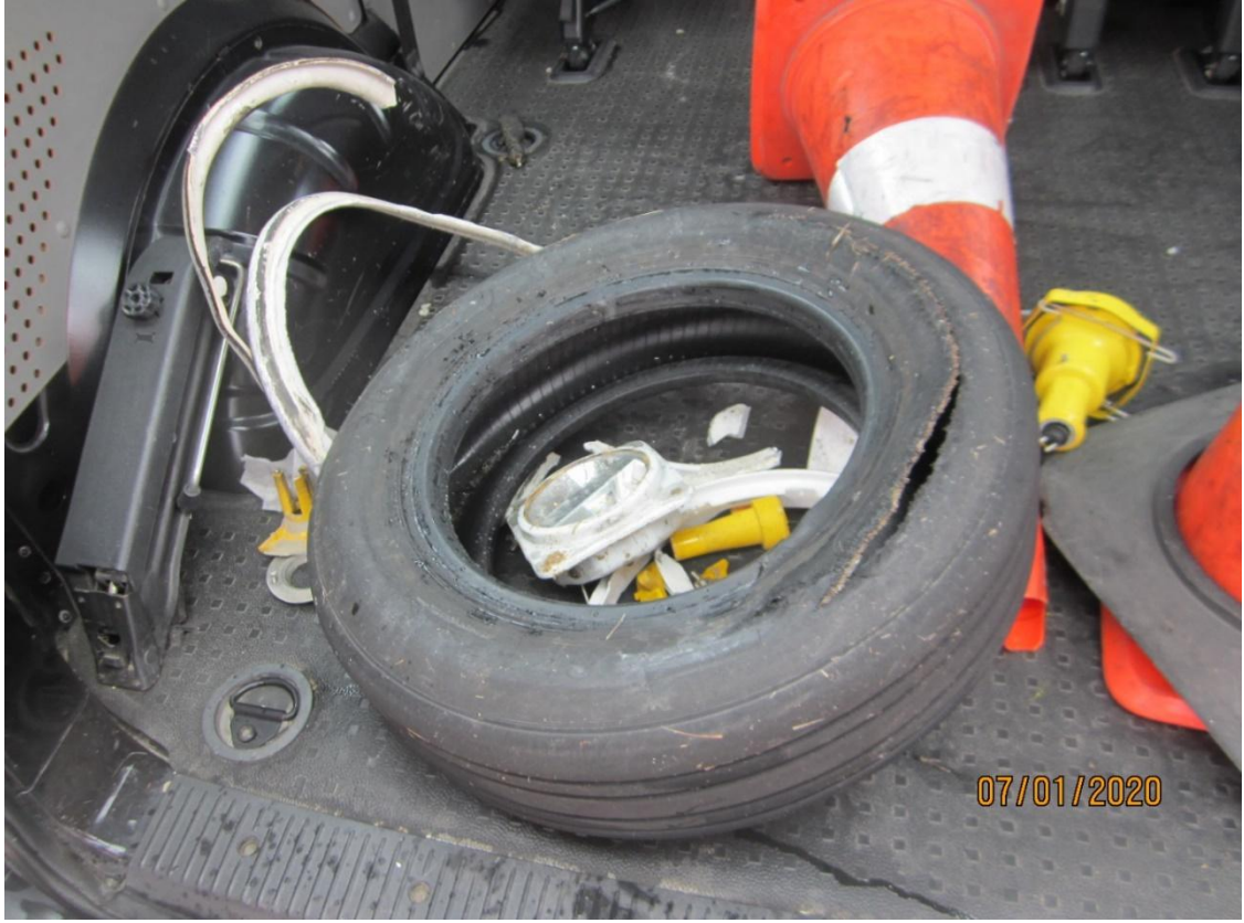
Resim-4: Kırılan Sağ Burun Jantı
