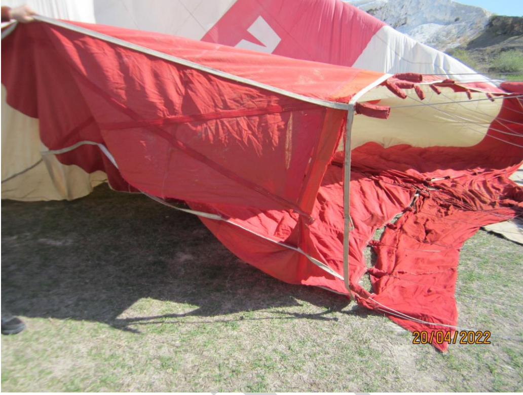
Resim-3: Kubbe Hasarı
