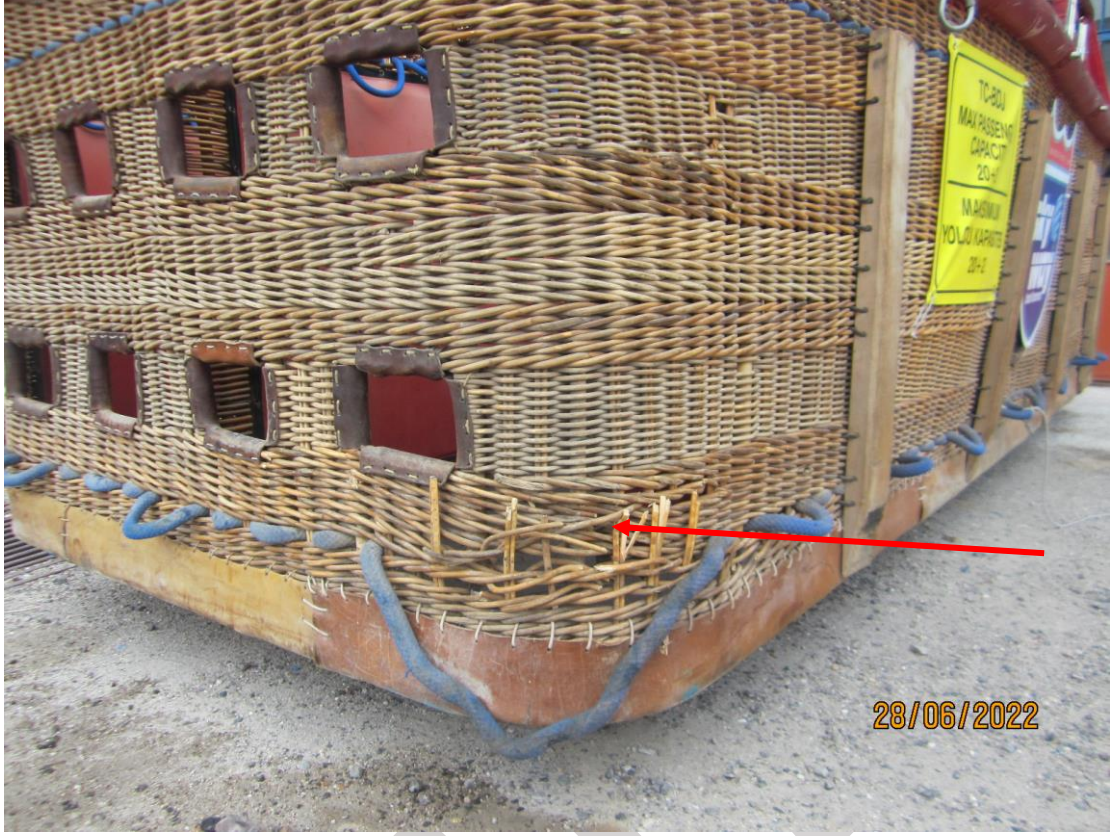
Resim-4: Sepet Ön Sol Bölümdeki Rattan Hasarı
