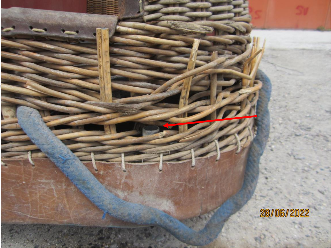
Resim-5: Sepet Ön Sol Bölümdeki Rattan Hasarı
