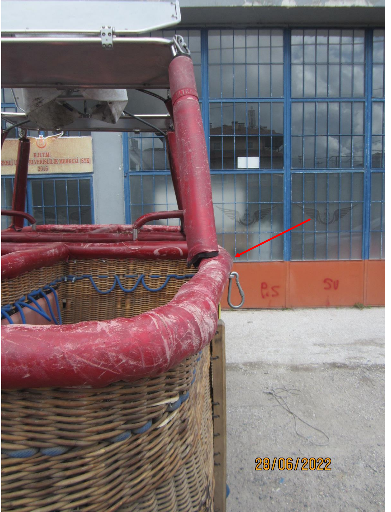
Resim-3: Sepet Üst Çerçeve'deki Eğrilik
