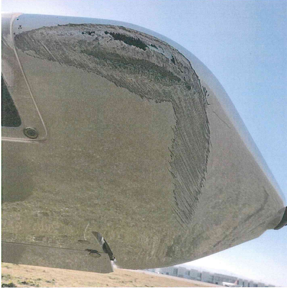
Resim-4: Hava Aracındaki Hasarlar
