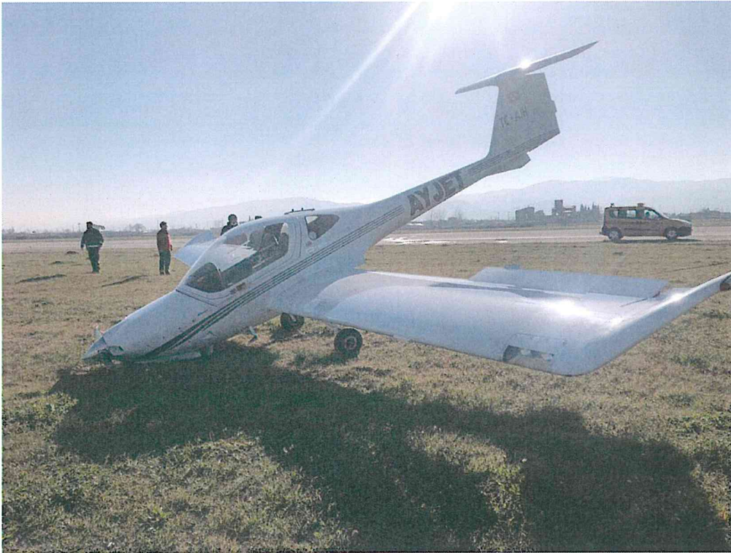
Resim-2: Hava Aracındaki Hasarlar
