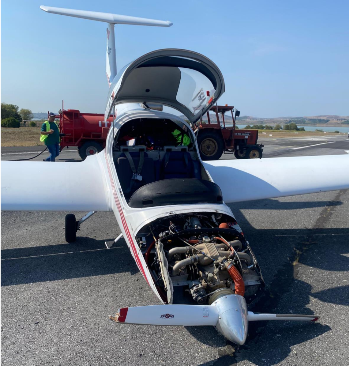
Resim-3: Pervane Hasarı
