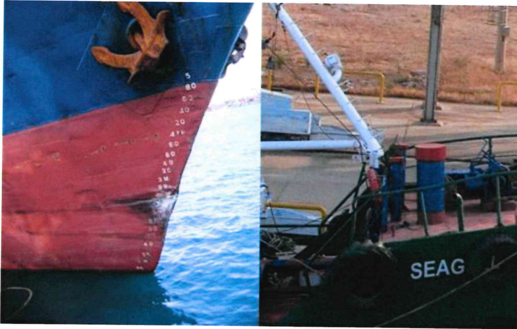
Resim 5 YILMAZ KAPTAN'da ve SEAGULL EGE 7'de Oluşan Hasarlar
