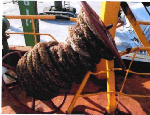
Resim 7 Koparak Kazaya Neden Olan Tambur
