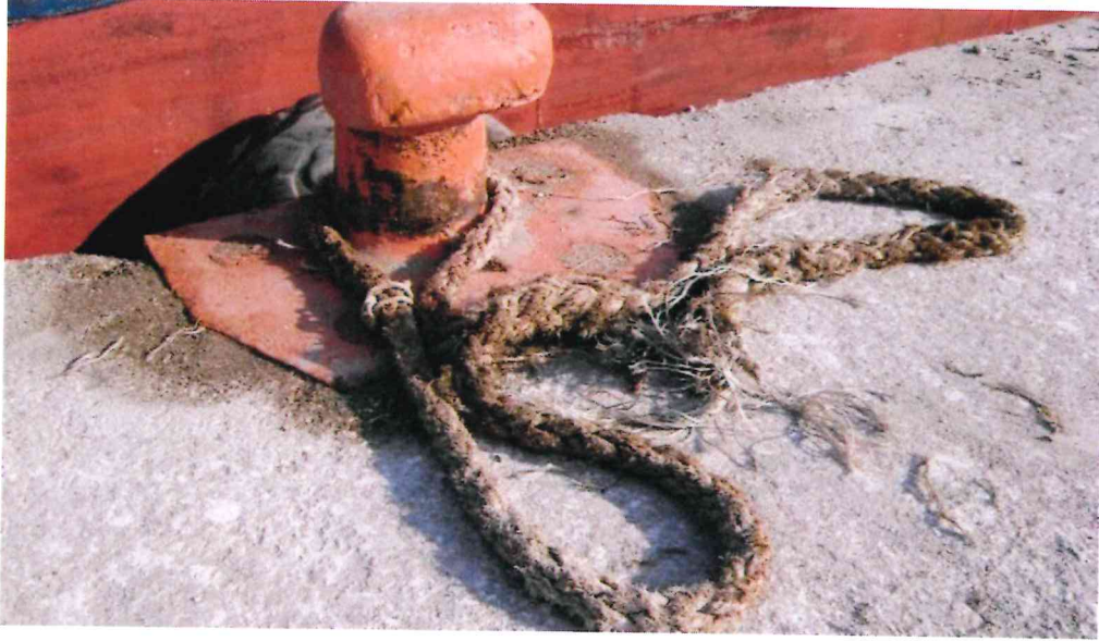
Resim 6 Kopan Halat Parçasının Babada Kalan Kısım
