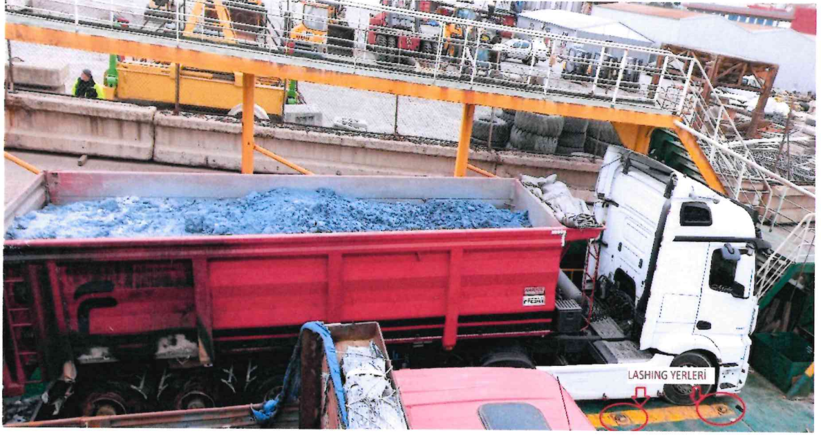
Resim 18 Kaza sonrası araçların Lashing işlemi yapılmadığı görülmüştür.
