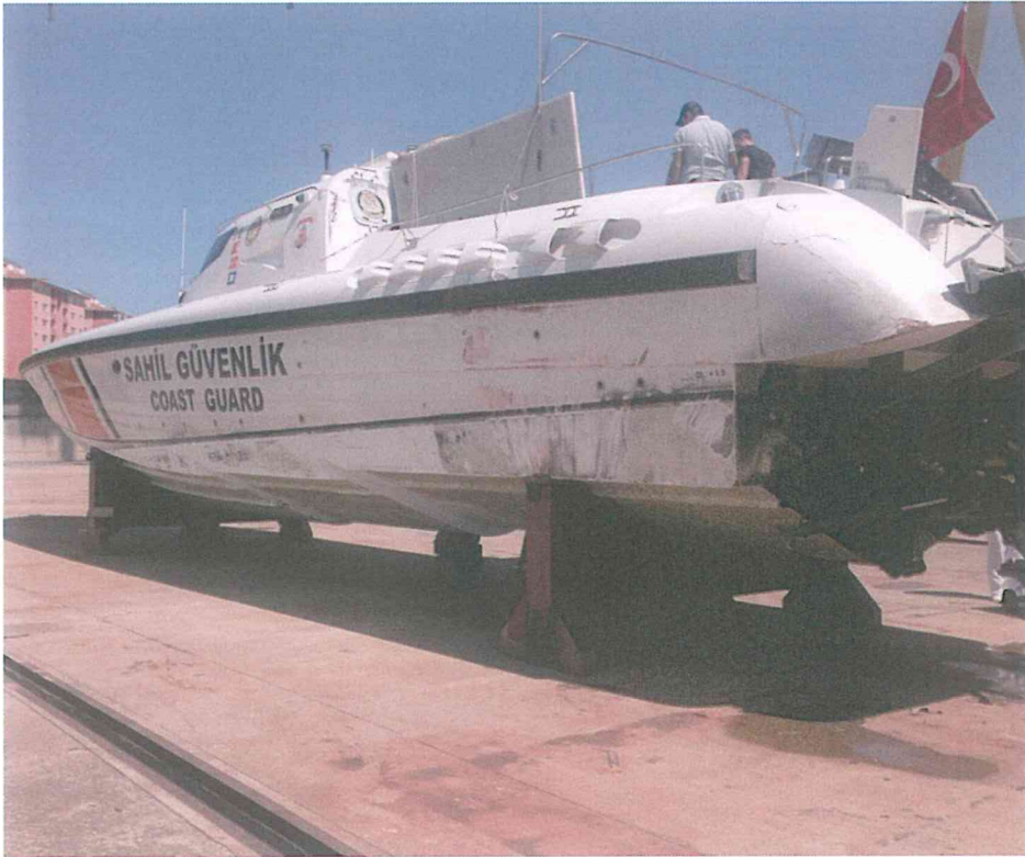
Resim 13: TCSG 25 Botun İskele Kıç Omuzluğunda Meydana Gelen Hasar
