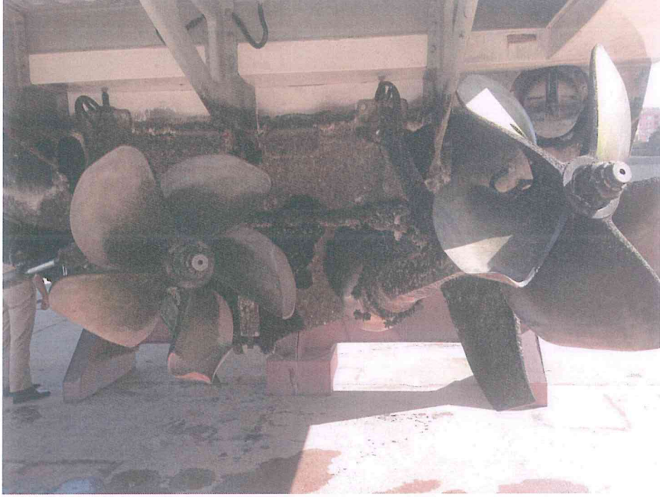
Resim 12: TCSG 25 Botun Hasar Gören Pervaneleri
