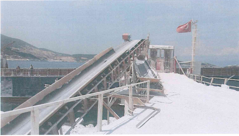
Resim 13 : ERS İskelesindeki Sabit Konveyör
