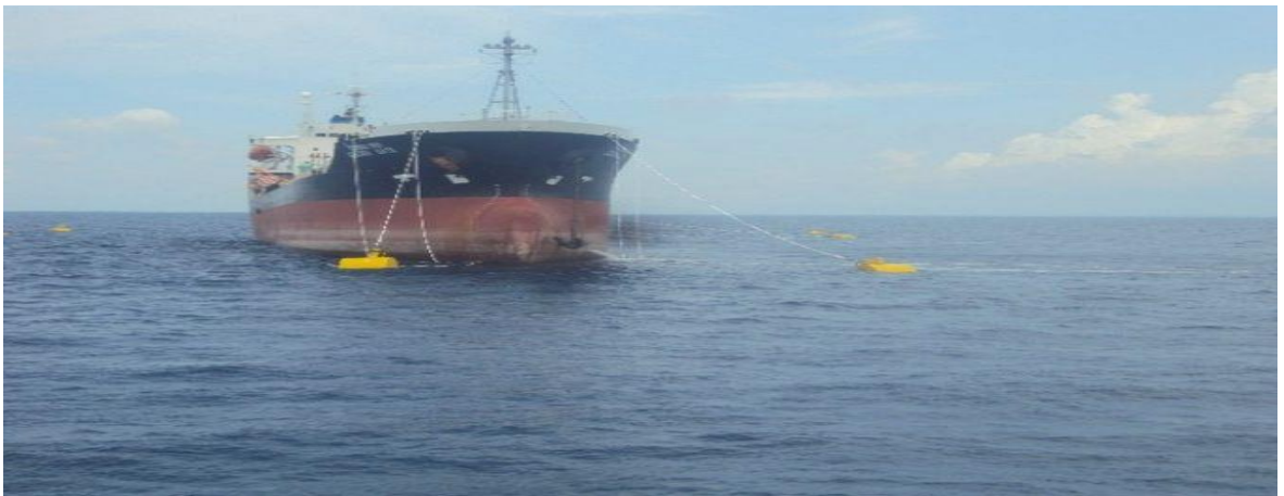
Resim17: Örnek bir Geminin Bağlama Şamandırısına bağlanması
