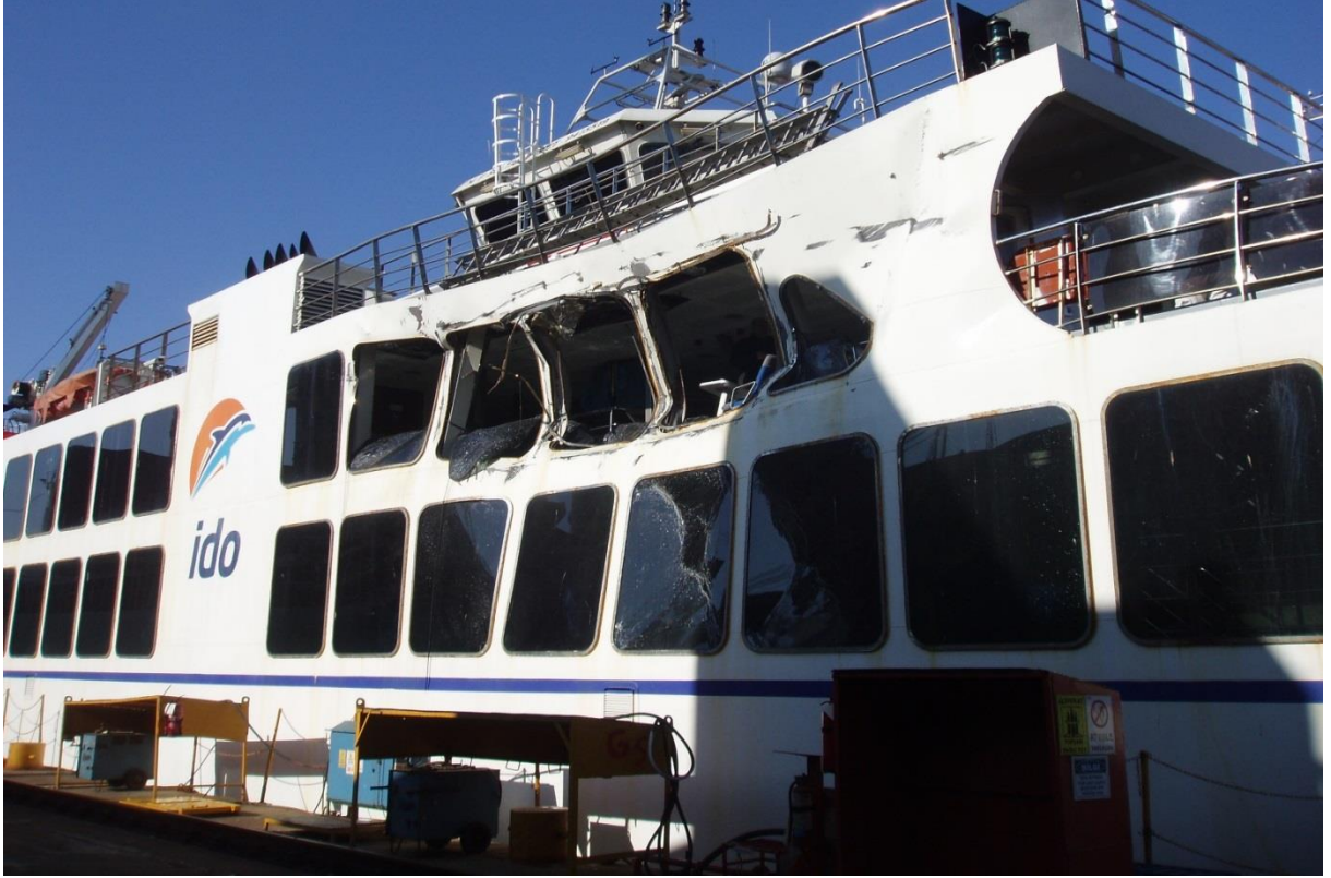
Resim 16: SULTANAHMET Gemisi Bordasındaki Hasar
