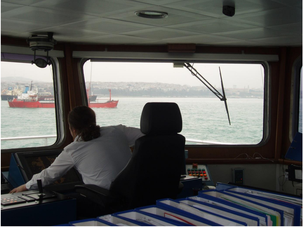
Resim 13: SULTANAHMET Geminin Köprüüstünde Kör Noktaya Neden Olan Dikme
