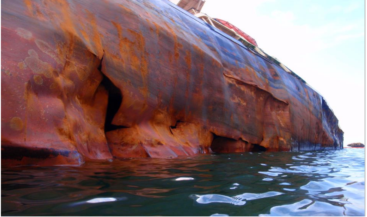
Resim 6: SEA BRIGHT Gemisinde kaza sonrası oluşan yırtılmalar
