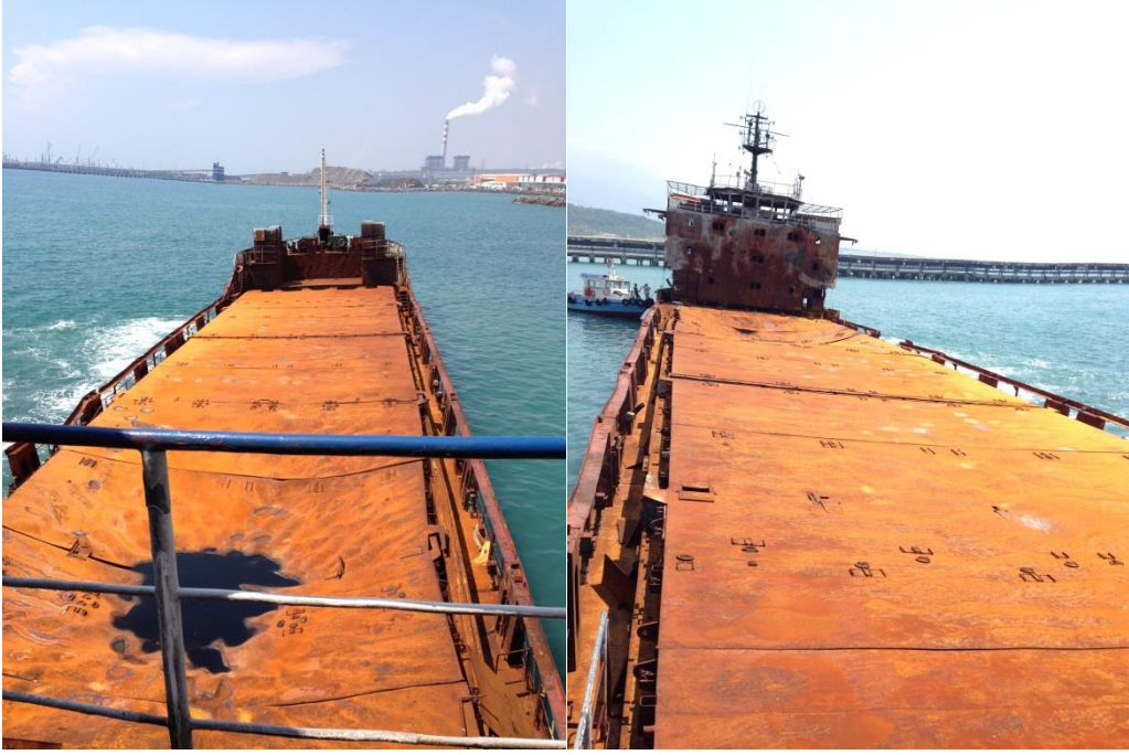
Şekil 5. Yangın sonrası geminin güvertesi ve üst bina
