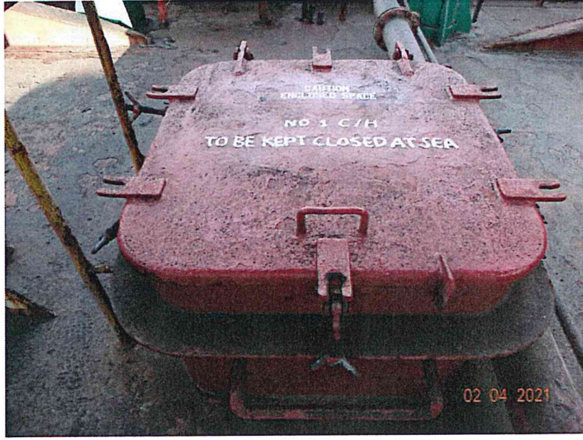
Resim 12 Kaza sonrası menhol kapağı işaretlemenin belginkenleştirilmesi ve “DİKKAT KAPALI ALAN” yazısı
