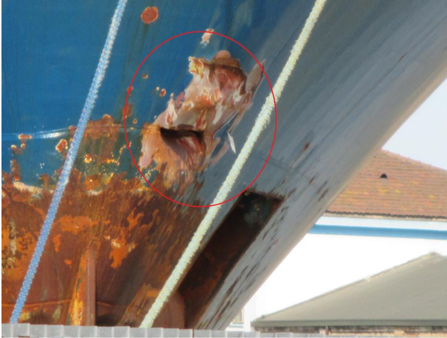
Resim 23: atıřma Sonrası LADY AZİZA Geminde Oluřan Hasar
