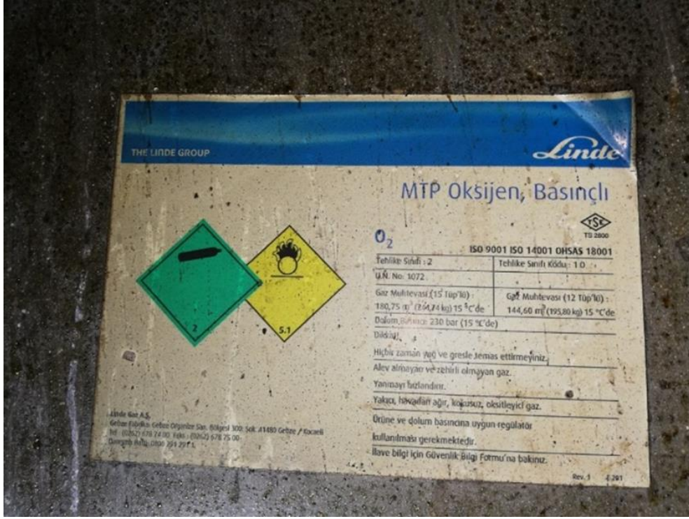
Resim 5: Oksijen tüplerinin UN numarası ve tehlike sınıfını gösteren etiket
