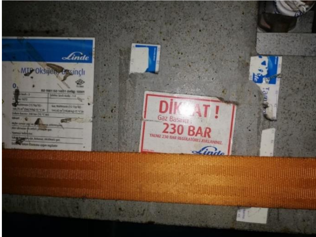
Resim 4: Oksijen tüplerinin bağlı olduğu palettteki basınç etiketi
