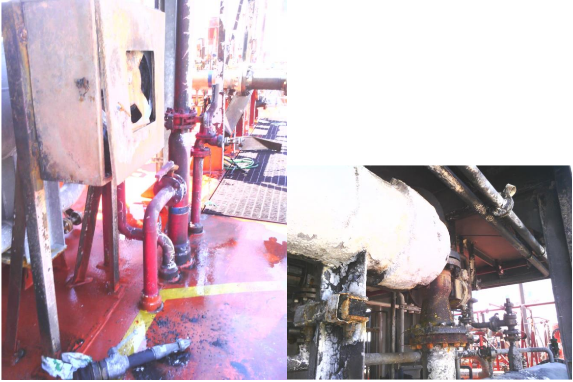
Resim 20: Patlama Nedeniyle Kırılan Gösterge Panosu Camı ve Köprüüstü Penceresi
