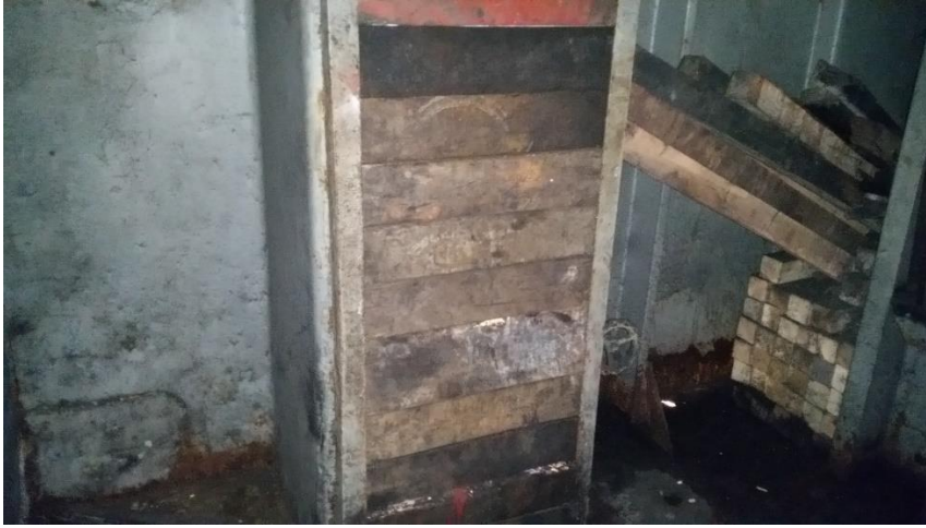
Resim 11: Yükleme İşleminde Önce Latalarla Örülen Ambar-Tünel Geçışı
