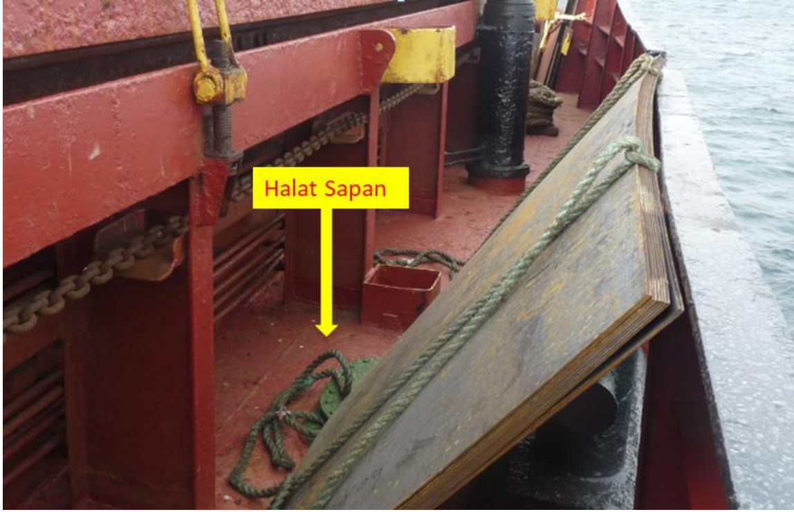
Resim 16:Saç Plakaların Gemiye Verilmesinde Kullanılan Halta Sapanlar
