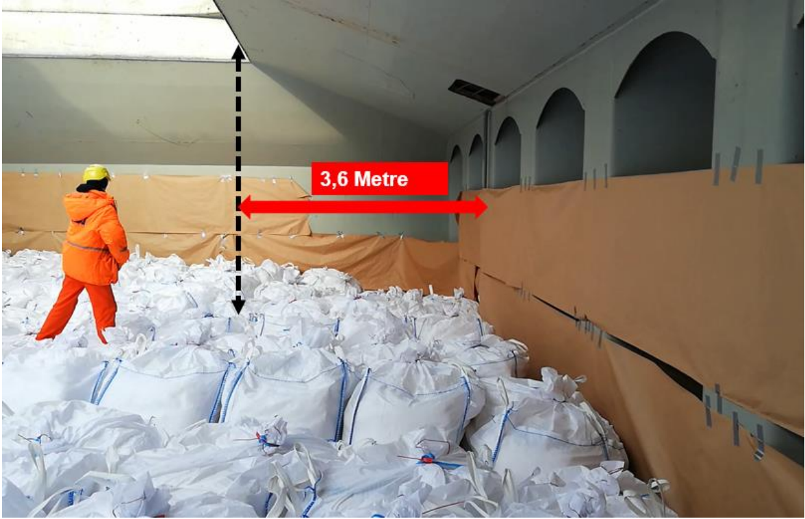
Resim 12: Ambar Ağız İle Ambar Kıç Perdesi Arasındaki Mesafe
