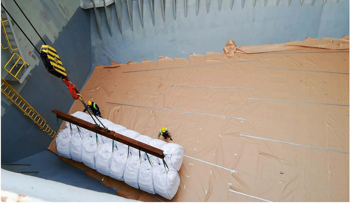
Resim 8: Yü­k­ün Ambar İ­çerisine İndirilme Görüntüsü ve Ambar Tabanına Yapıştırılan Kağıt
