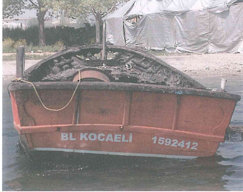
Resim 10:Yangın Sonrası SERDAR 2 İsimli Acente Botunda Oluşan Hasar
