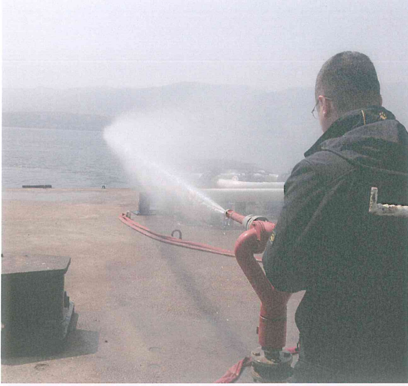
Resim 27: Yangın Söndürme Çalışmalarında Kullanılan Su Topunun Menzili
