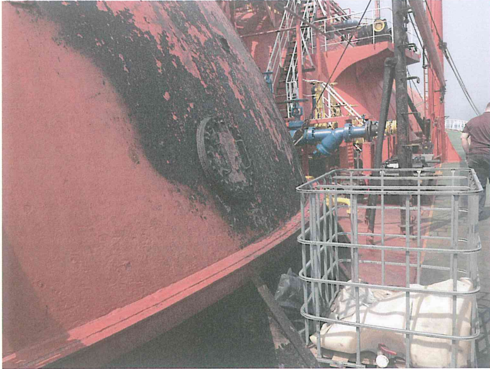
Resim 5: HABAŞ Gemisinde Meydana Gelen Yangın Hasarı.
