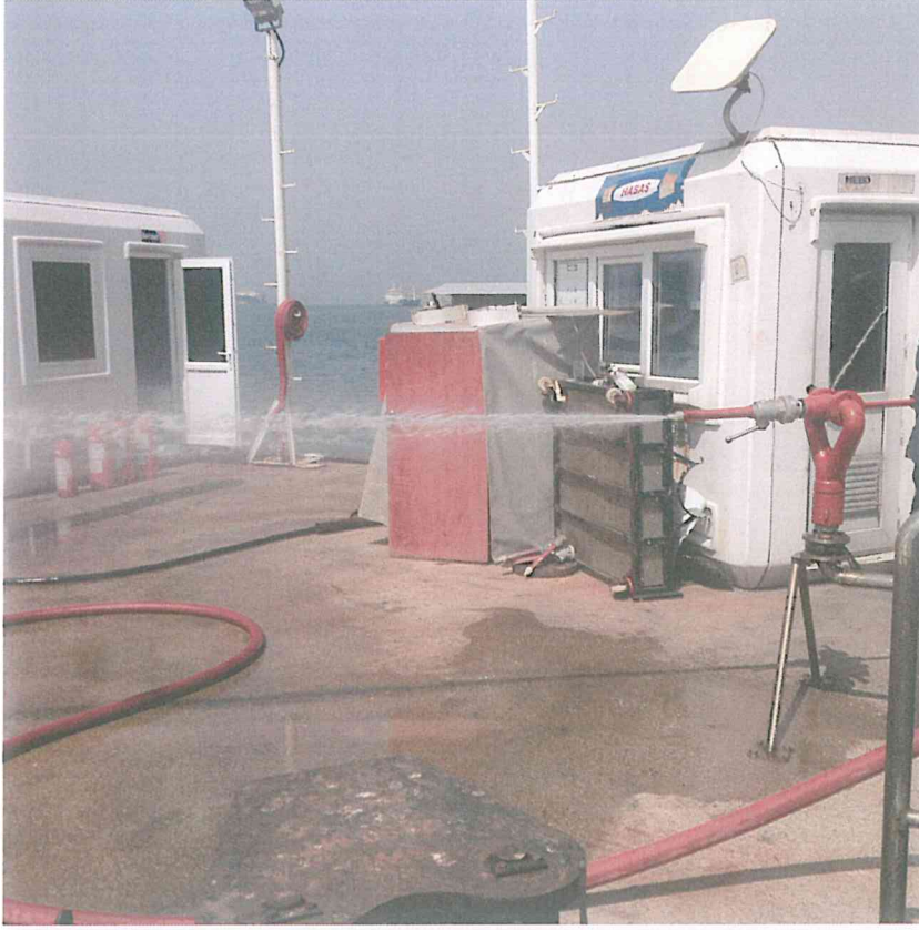
Resim 26 :Yangın Söndürme Çalışmalarında Kullanılan Su Topu
