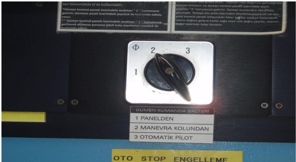
Resim 15: Dümen Kumanda Seçici Anahtarı (Şalteri)
