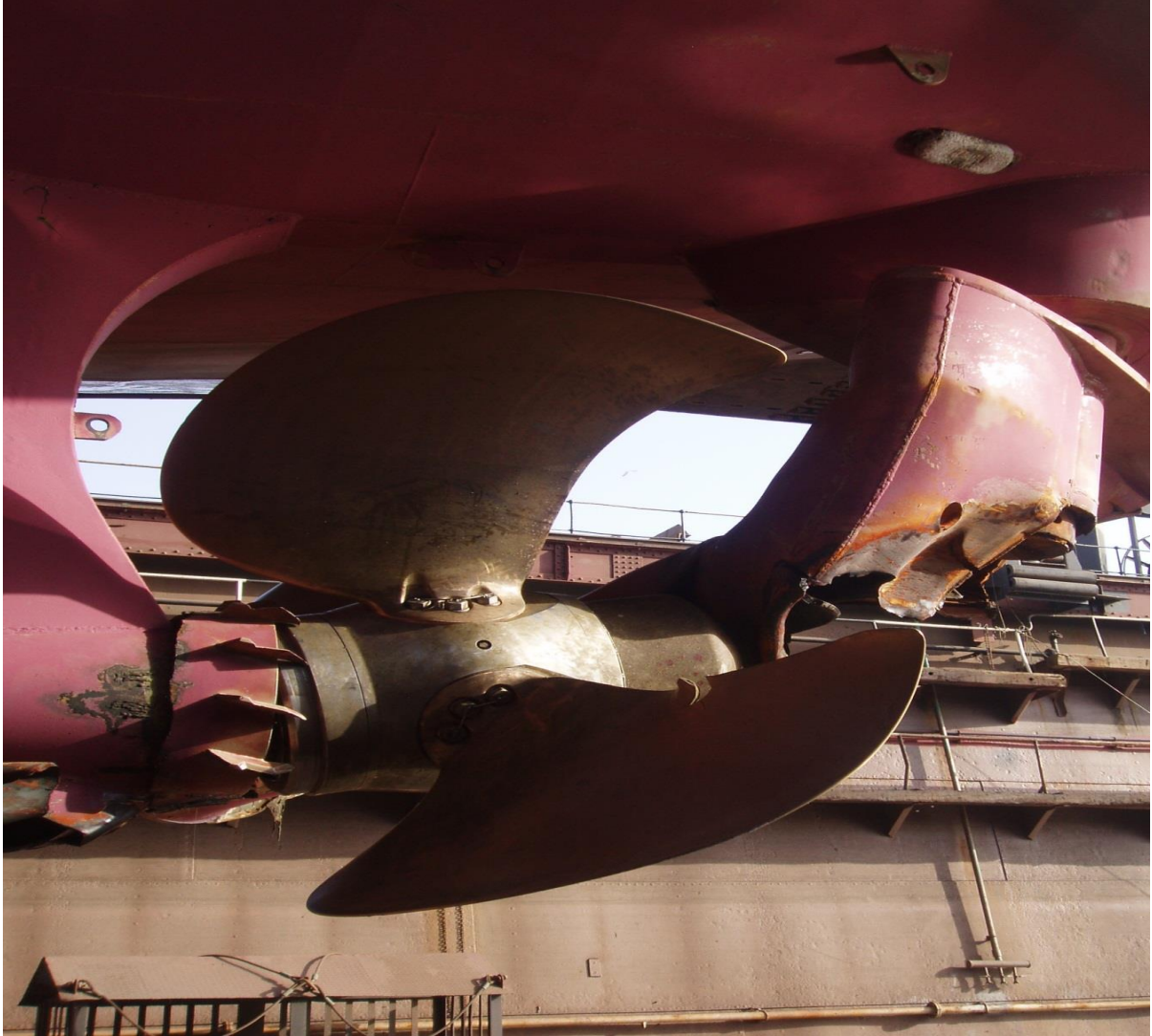
Resim 16: Hasarlı Dümen ve Pervane
