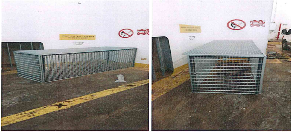
Resim 28 Ambar sintinelerinin tıkanmaması için mazgalların üzerlerine yapılan kafesler.
