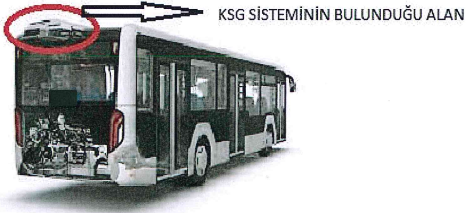
Resim 23 Yanan otobüs ve obüste yer alan KSG sisteminin bulunduğu konum.
