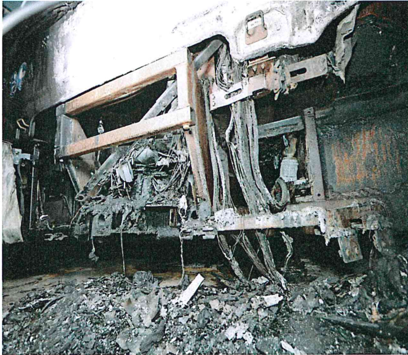
Resim 18 Ön tampon altındaki yangın hasar alanı.
