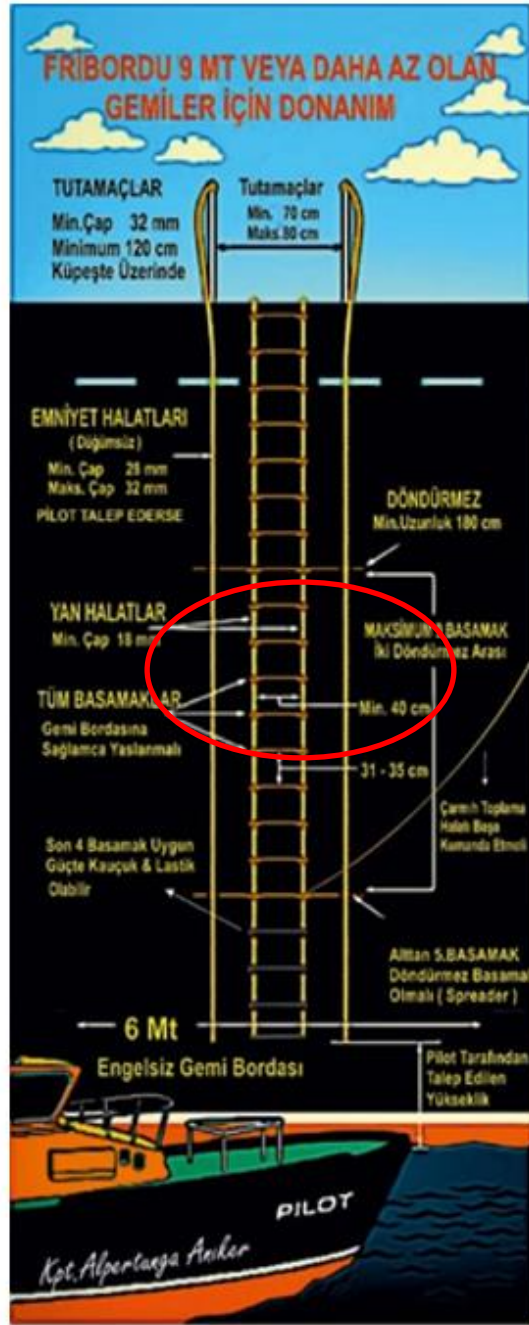
Resim 9 IMO Poster pilot çarmıhı uygulaması
