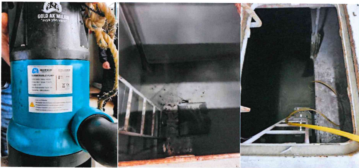
Resim 9 Ambar Sintine Kuyusu ve No 7. Ambar Dalgıç Pompa fotoğrafları
