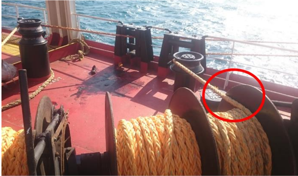
Resim 8: Geminin İskele Kıç Omuzluğunda Bulunan Halat Tamburu ve Fırdöndü
