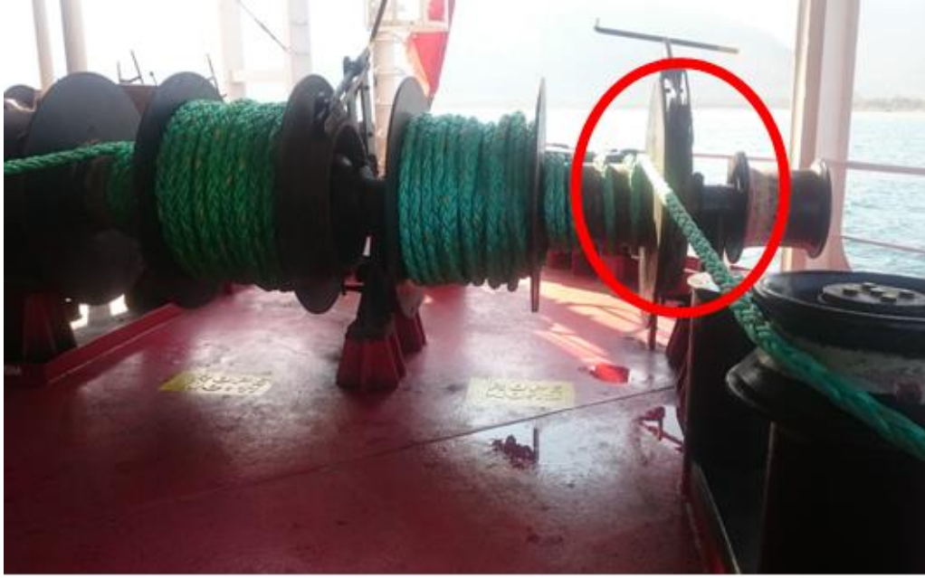
Resim 7: Geminin İskele Kıç Omuzluğunda Bulunan Halat Tamburu ve Fırdöndü
