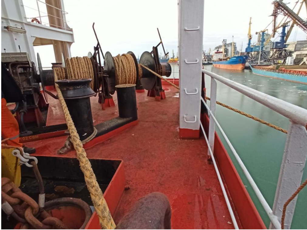
Resim 9: Palamar Halatı Bağlama Planına Göre Palamar Halatlarının Verilmesi.
