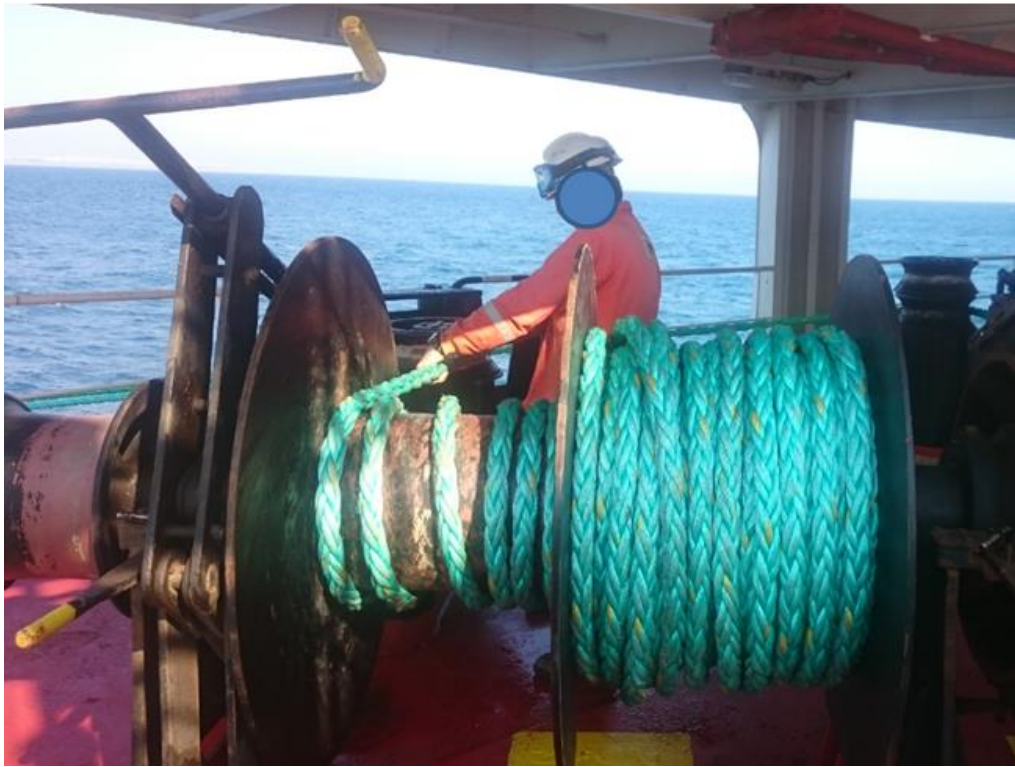
Resim 4: Tambur Diskine Sürten Palamar Halatlarının Gemiciler Tarafından Çekilmesi.
