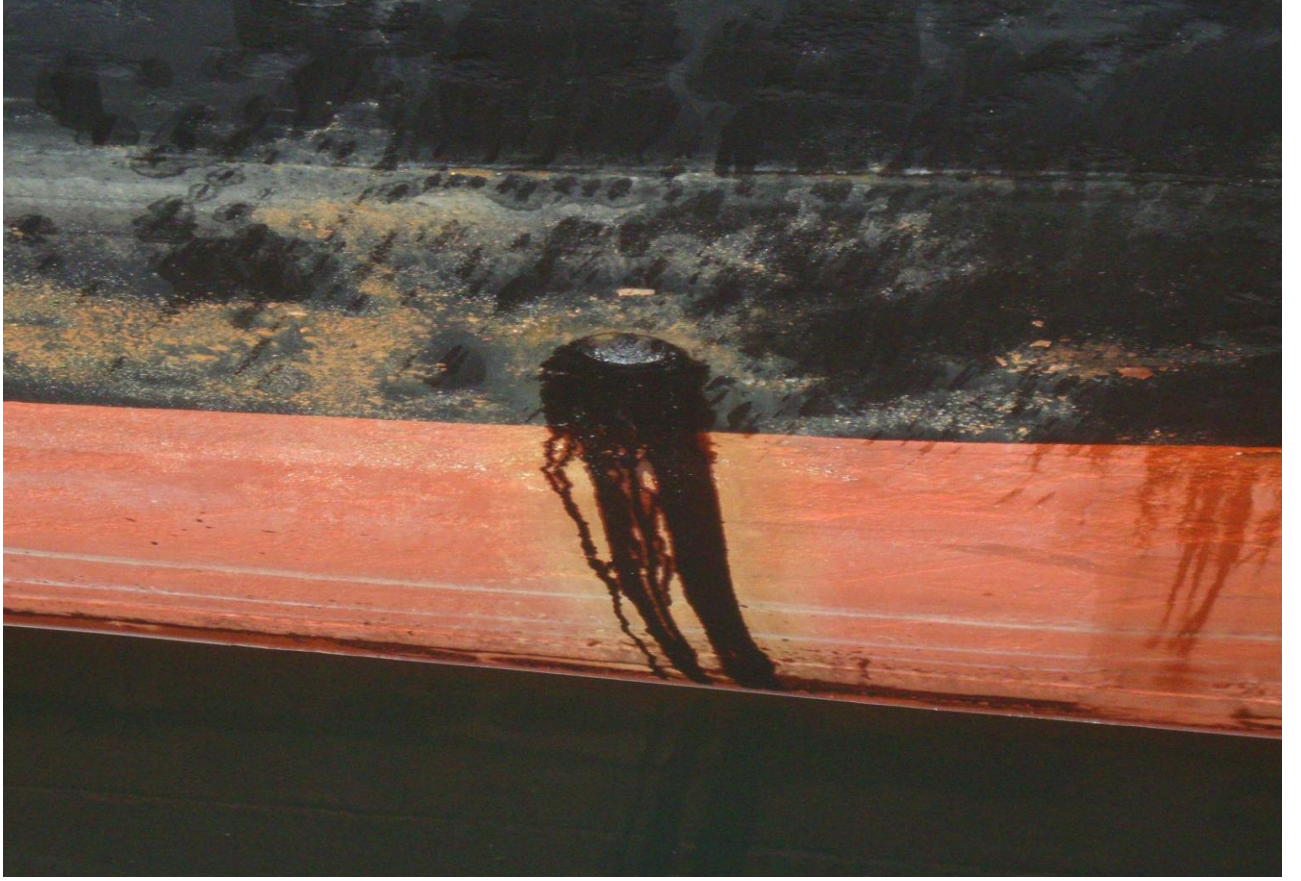
Resim 7: Taşan yakıtın frengi delikleri yoluyla denize sızması
