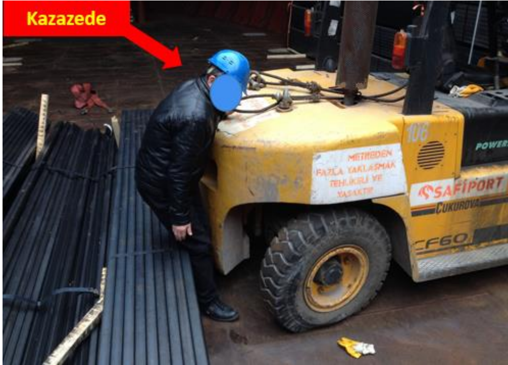
Resim 5: Profil Borular İle Forklift Arasına Sıkışan Kazazede 1
