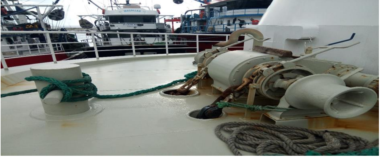
Resim 10: AKERKO Gemisinde uygulanan halat bağlama şekli
