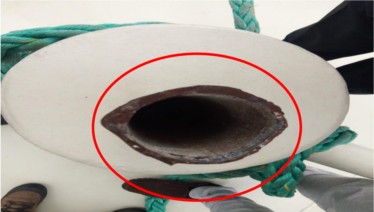
Resim15: Kopan babadaki kulakçıın saç kalınlığı
