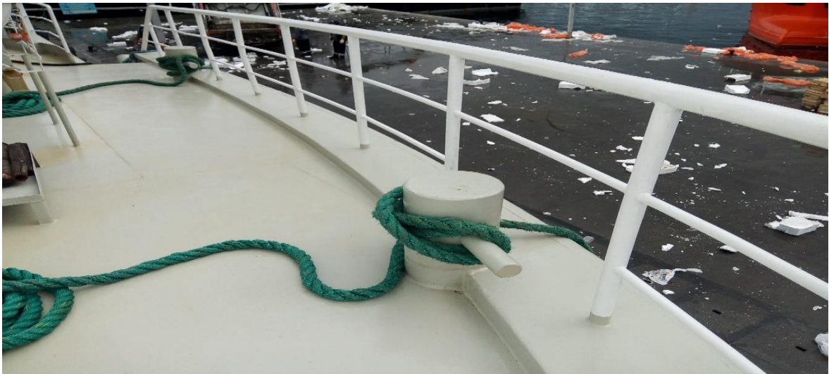
Resim 9: AKERKO Gemisinde uygulanan halat bağlama şekli.
