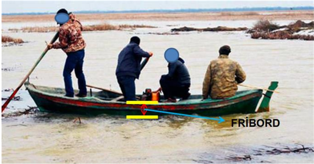
Resim 15 12: GICI gölünde benzer bir tekneye 4 kişi bindiğinde teknenin fribord yüksekliği.
