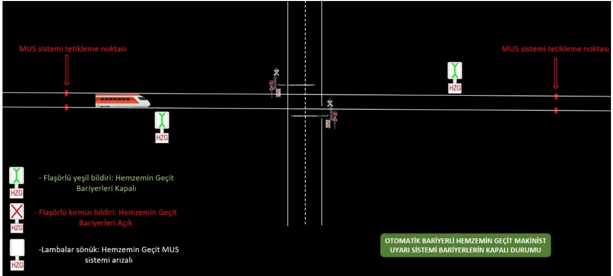
Resim 9 (Otomatik Bariyerli Geçit MUS bariyerler kapalı durumu)
