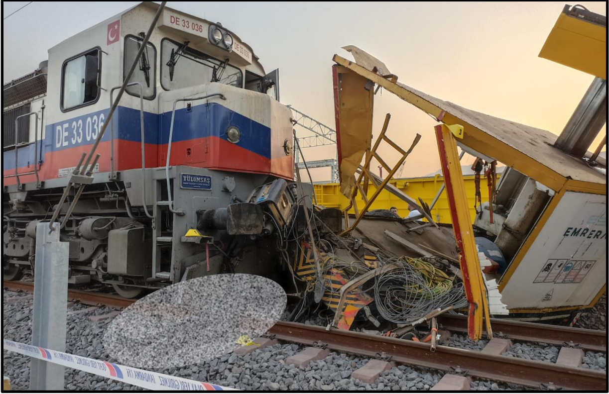
Şekil 9 Kaza sonrası Lokomotifin ön tarafı ve MDA Arka Kabini
