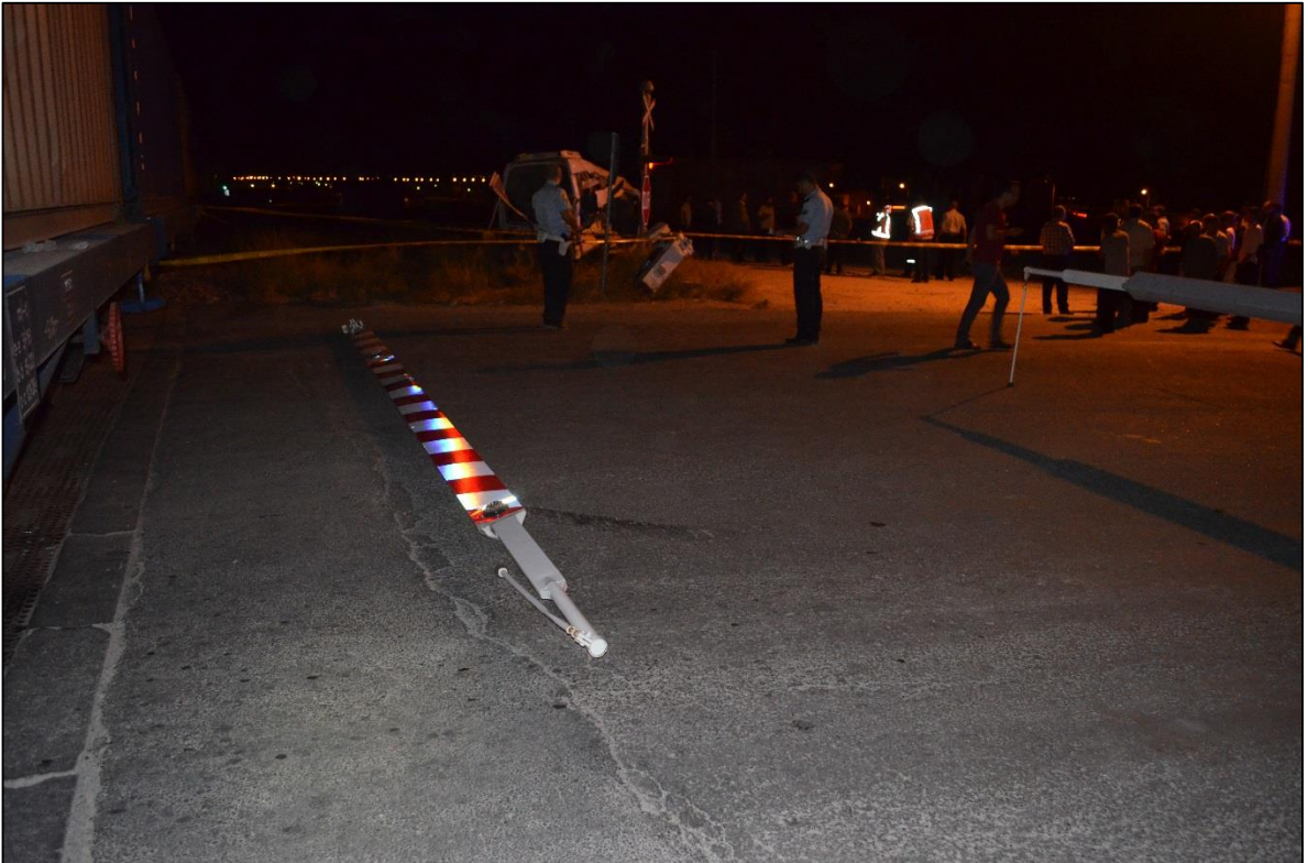
Resim 23: (Kaza sonrası kırılan bariyer ve kaidesi)
