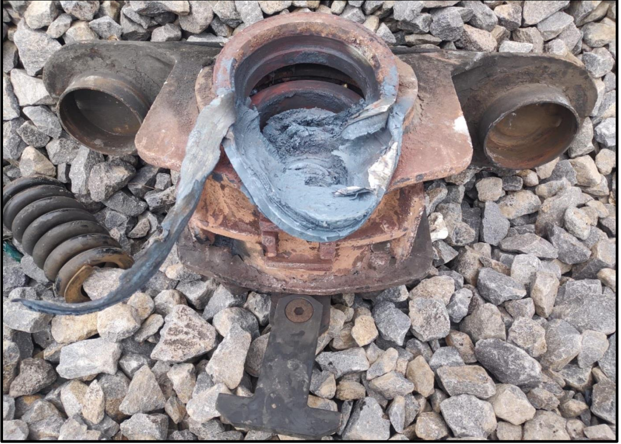
Resim 3 (Km:69+600 Deraydan önce vagonun ısınma sonucu düşen buatağresi)
