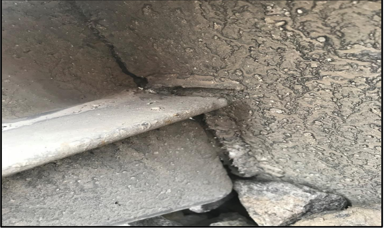
Resim 7 (Deray eden vagon bojisinde deraydan önce var olabileceği sonucuna varılan kırıklar)
