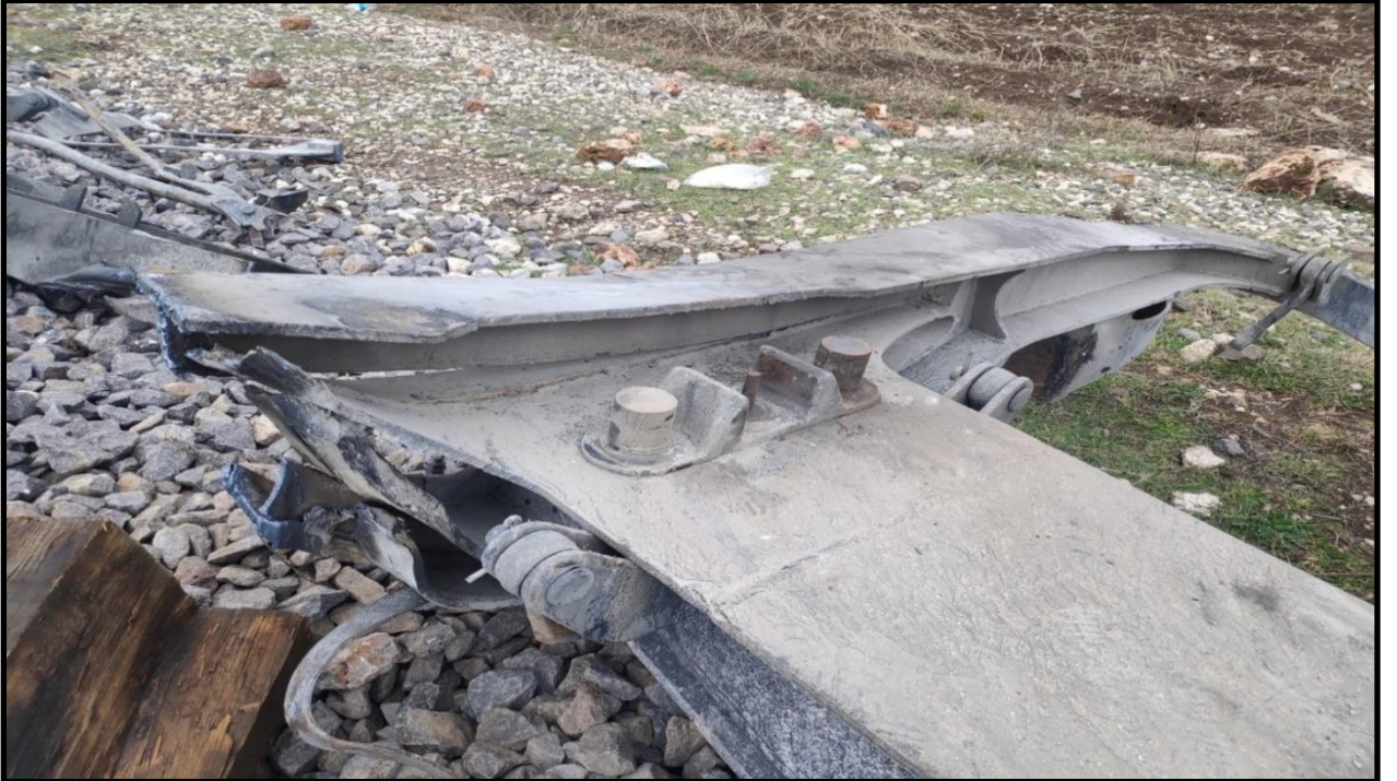
Resim 8 (Deray eden vagon bojisinde deraydan önce var olabileceği sonucuna varılan kırıklar)
