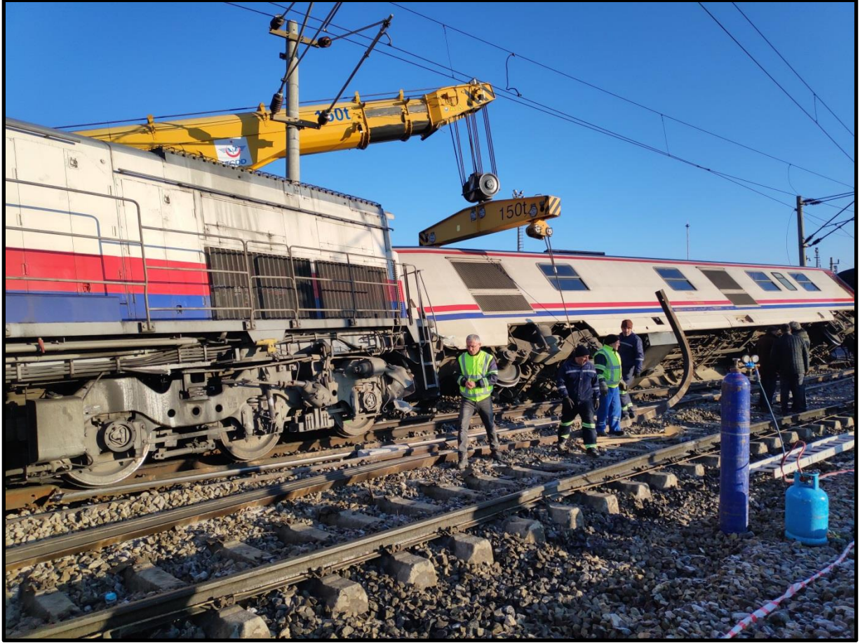
Resim 6 (Lokomotif ve jeneratör vagonunun deray kaldırma çalışmaları)
