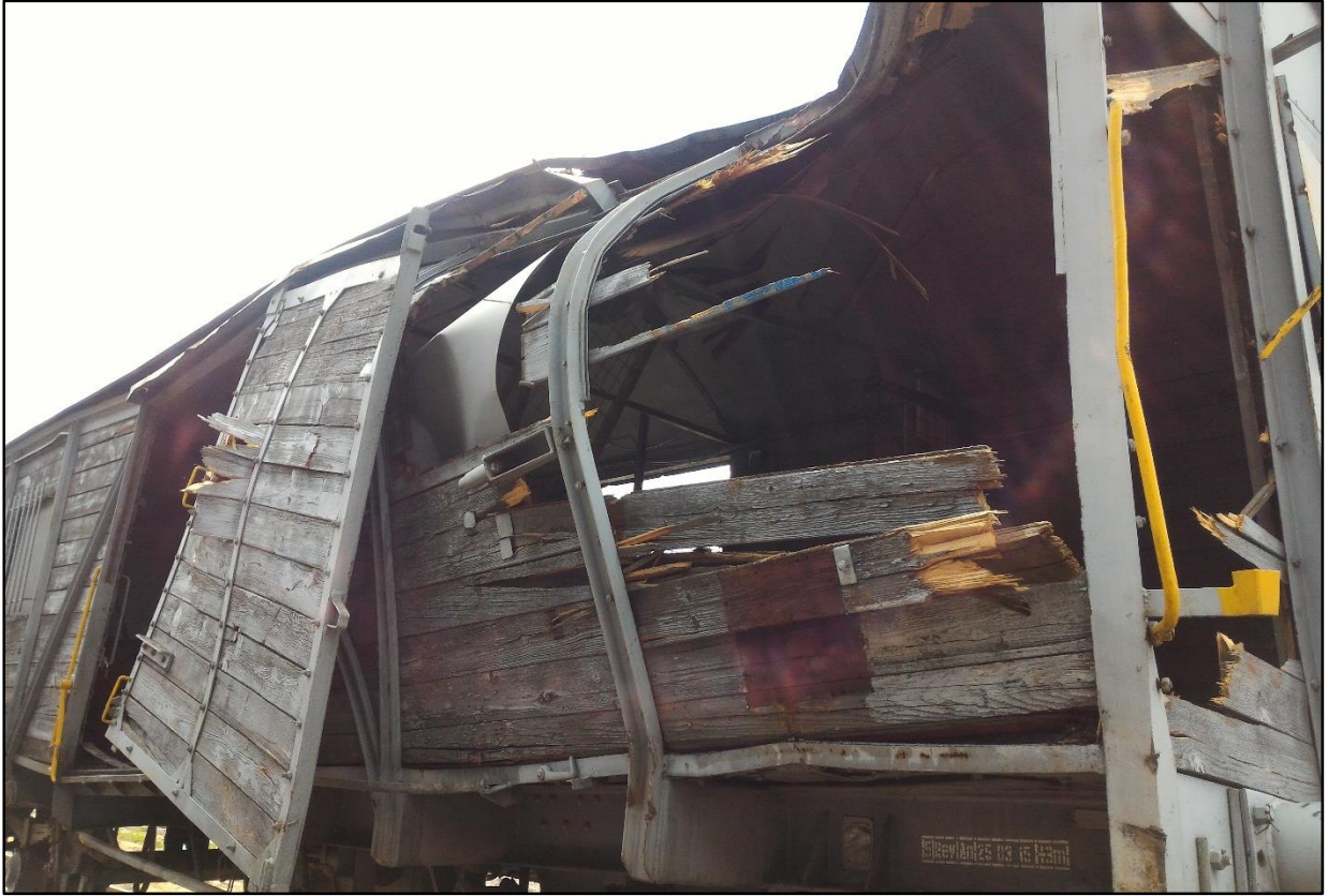
Resim 16 : (Deray eden 82205 jeneratör vagonu)
