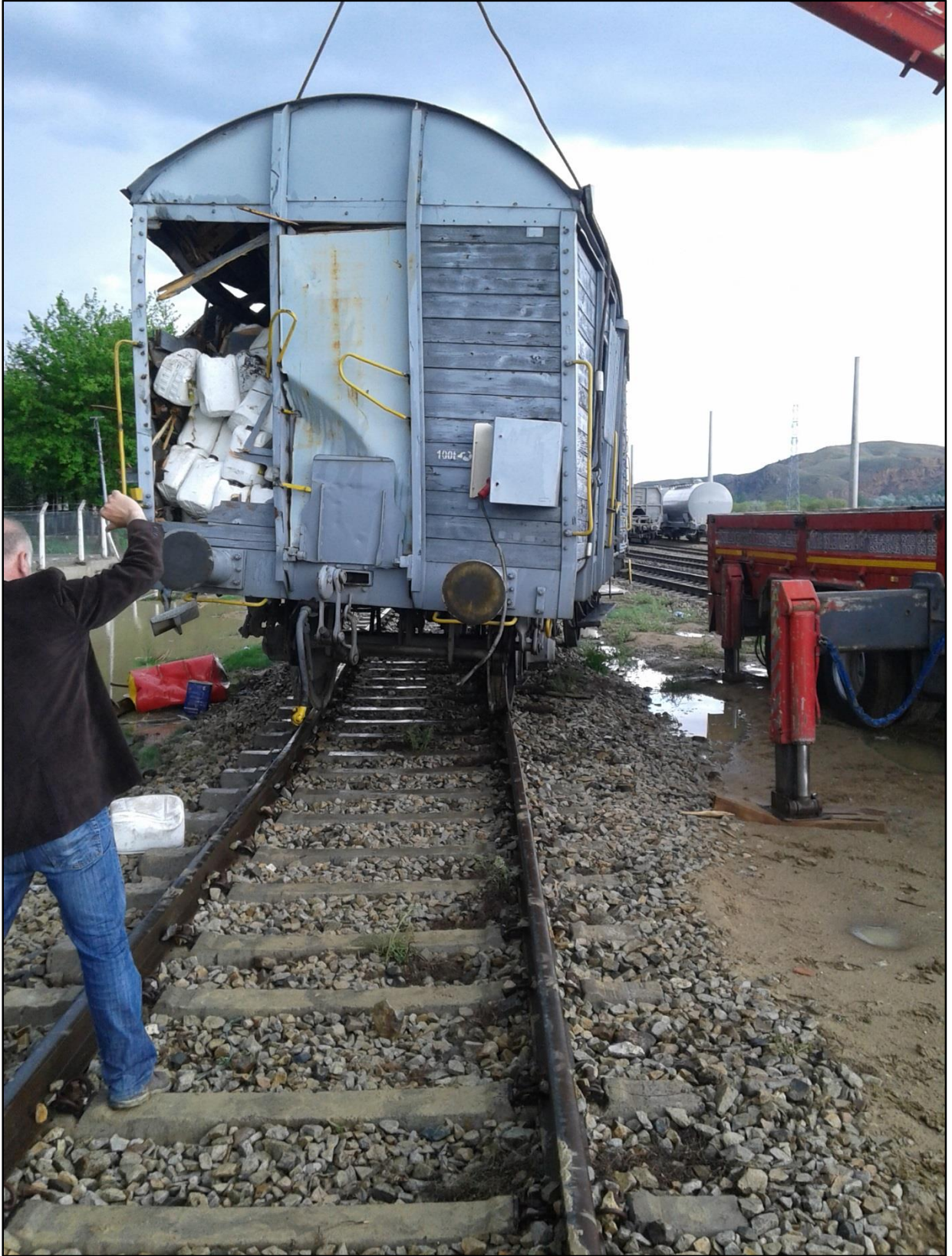
Resim 14 : (Deray eden 82205 jeneratör vagonu)
