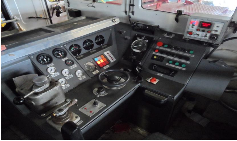
Resim 10 (24000'lik lokomotif kumanda kabini)
