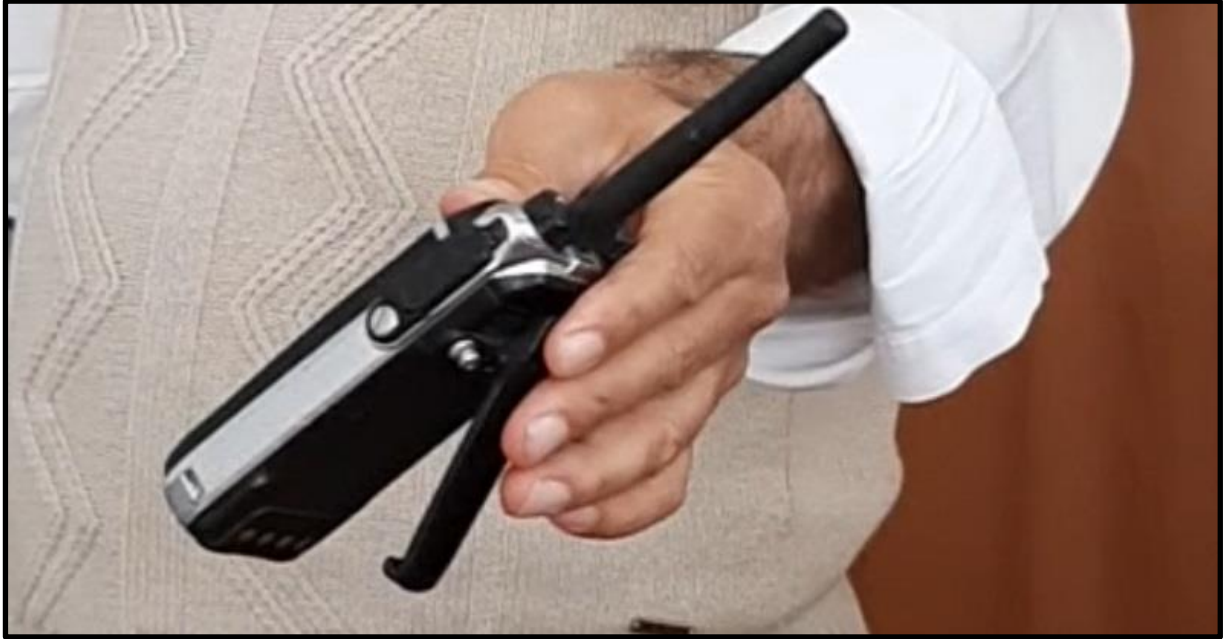
Resim 14 (Kazayı Geçiren Personele Ait Arka Mandalı Gevşetilmiş Telsiz)
