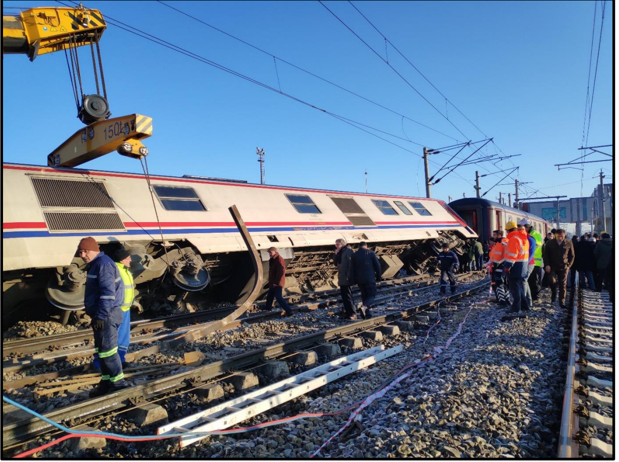
Resim 14 (Deray Kaldırma Çalışmaları)
