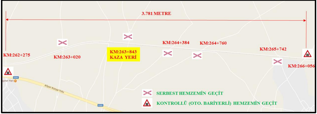
Resim 6 Kaza Güzergahındaki Hemzemin Geçitler
